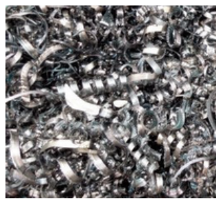
Cavacos de alumínio, Quebrados
