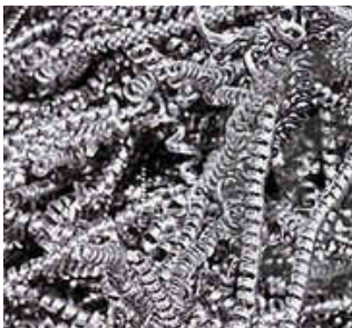
Cavacos longos, Espiralados, tipo fita
