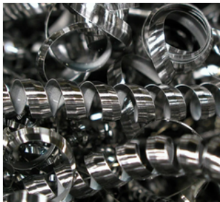
Cavacos longos, Espiralados, tipo fita
